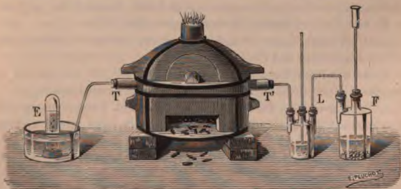
Fig. 149. — Production de l'oxyde de carbone par le charbon et l'acide carbonique.
